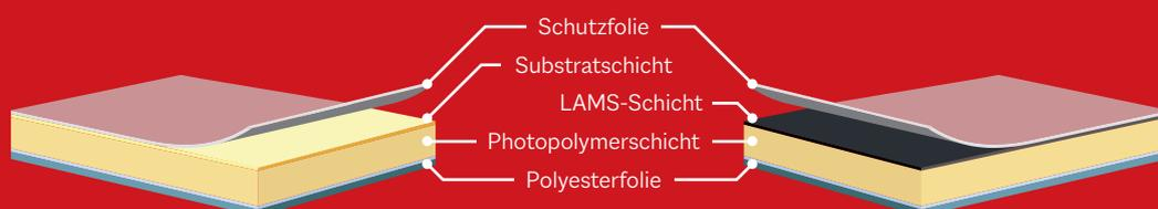
Die nyloflex® Seal F sind Einschichtenplatten, die aus einer lichtempfindlichen Photopolymerschicht und einem Polyesterträger bestehen.
