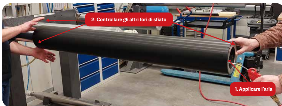
Fig. 2: Manutenzione dei fori di drenaggio
